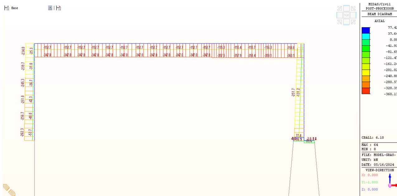
Náhled na vnitřní síly N v kombinaci ULS
